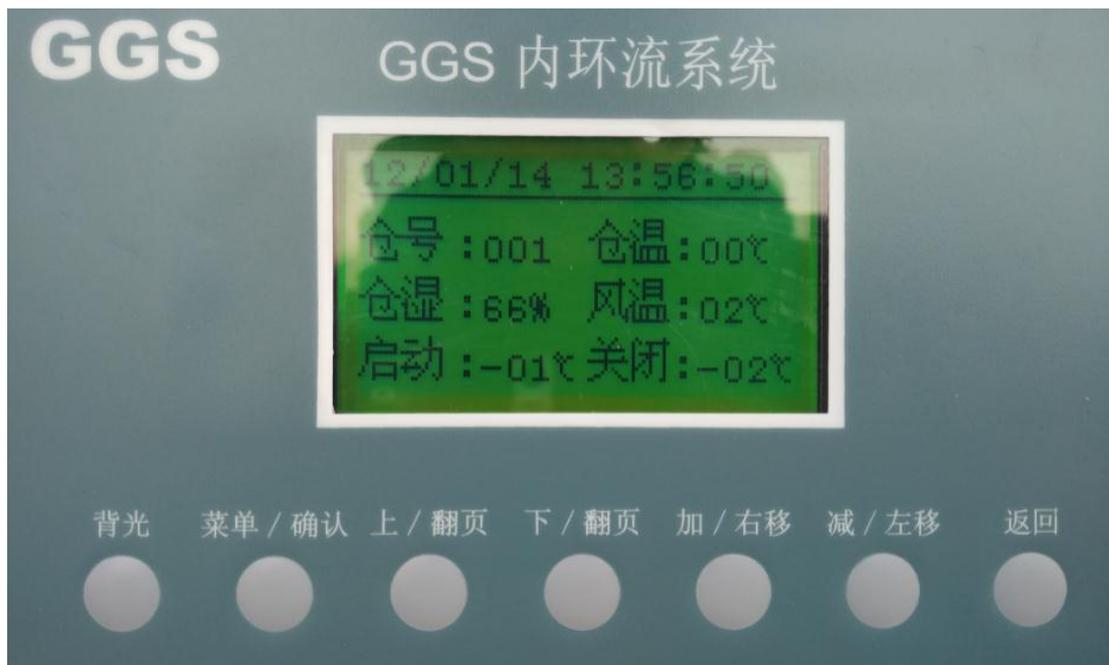
LED 屏幕初始界面显示内容为：时间、仓号、仓温、仓湿、风温、启动温度、关闭温度。时间为实时时间。仓号为所在粮仓的仓号，可编辑。仓温为粮仓内温度。仓湿为粮仓内湿度。风温为通风口空气温度，启动温度是在自动模式下，内环流系统自动启动的温度标定值。关闭温度是在自动模式下，内环流系统自动关闭的温度标定值。
