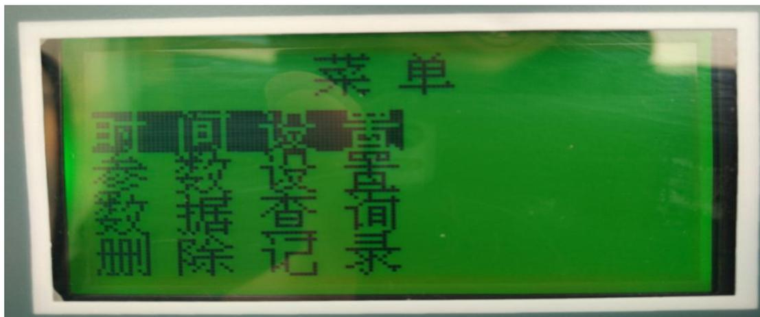
LED 数据显示及控制器的主要操作在“菜单”界面。主要包含以下内容：时间设置、参数设置、数据查询、删除记录。
