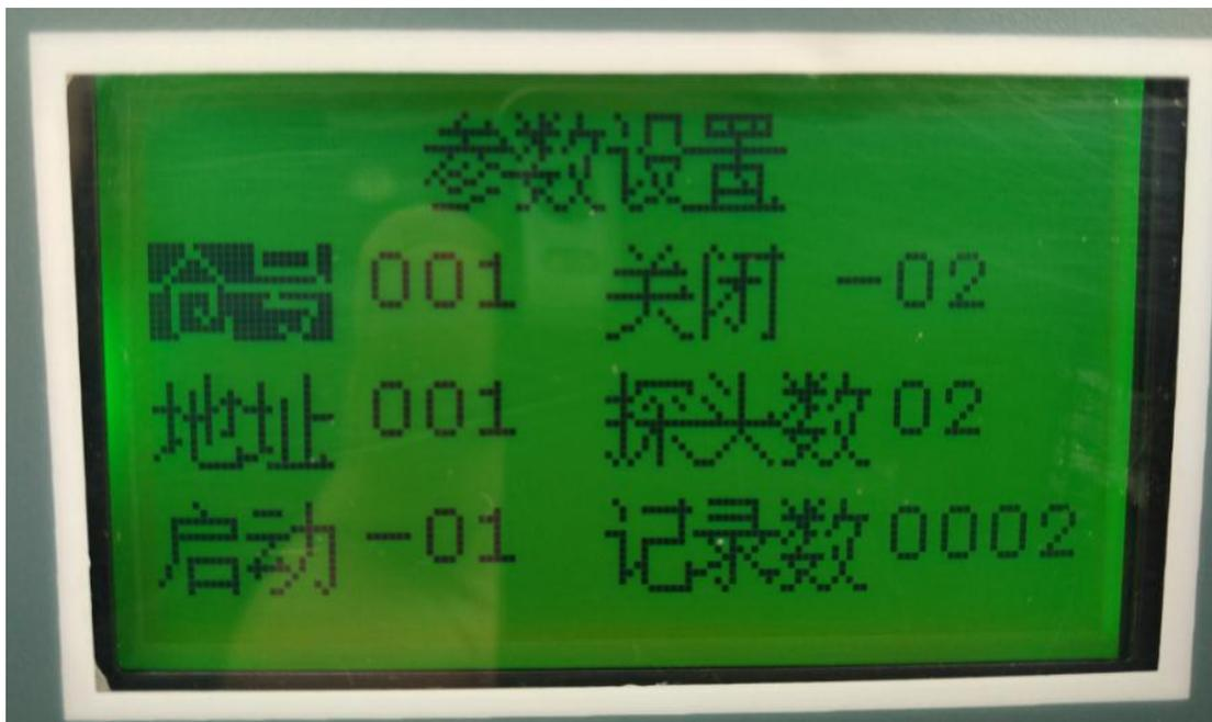
次界面主要针对：仓号、地址、启动温度、关闭温度、探头数、记录数进行操作。
